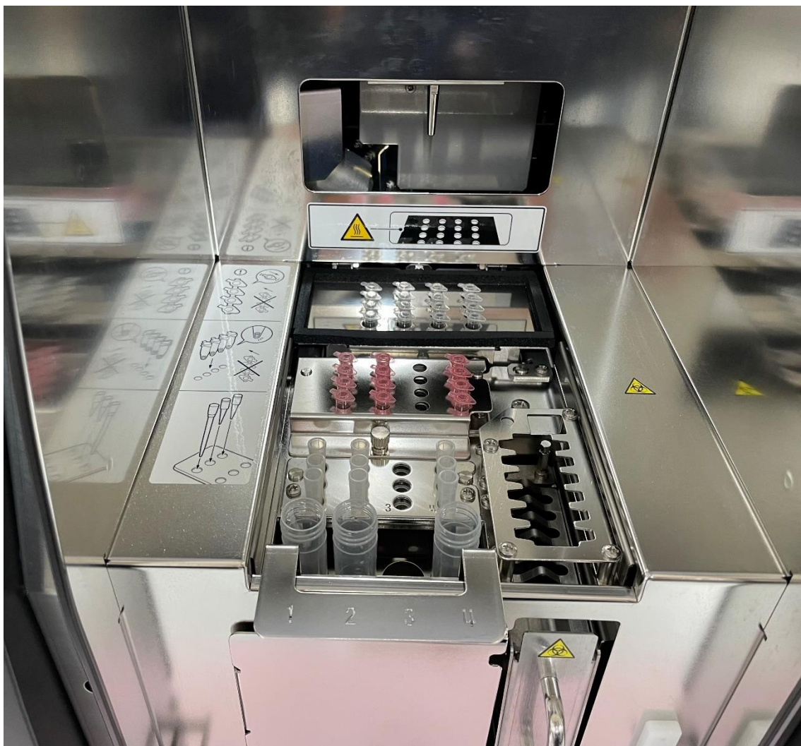
■機器本体の内部 上から反応容器、試薬容器、分注チップ、検体容器
